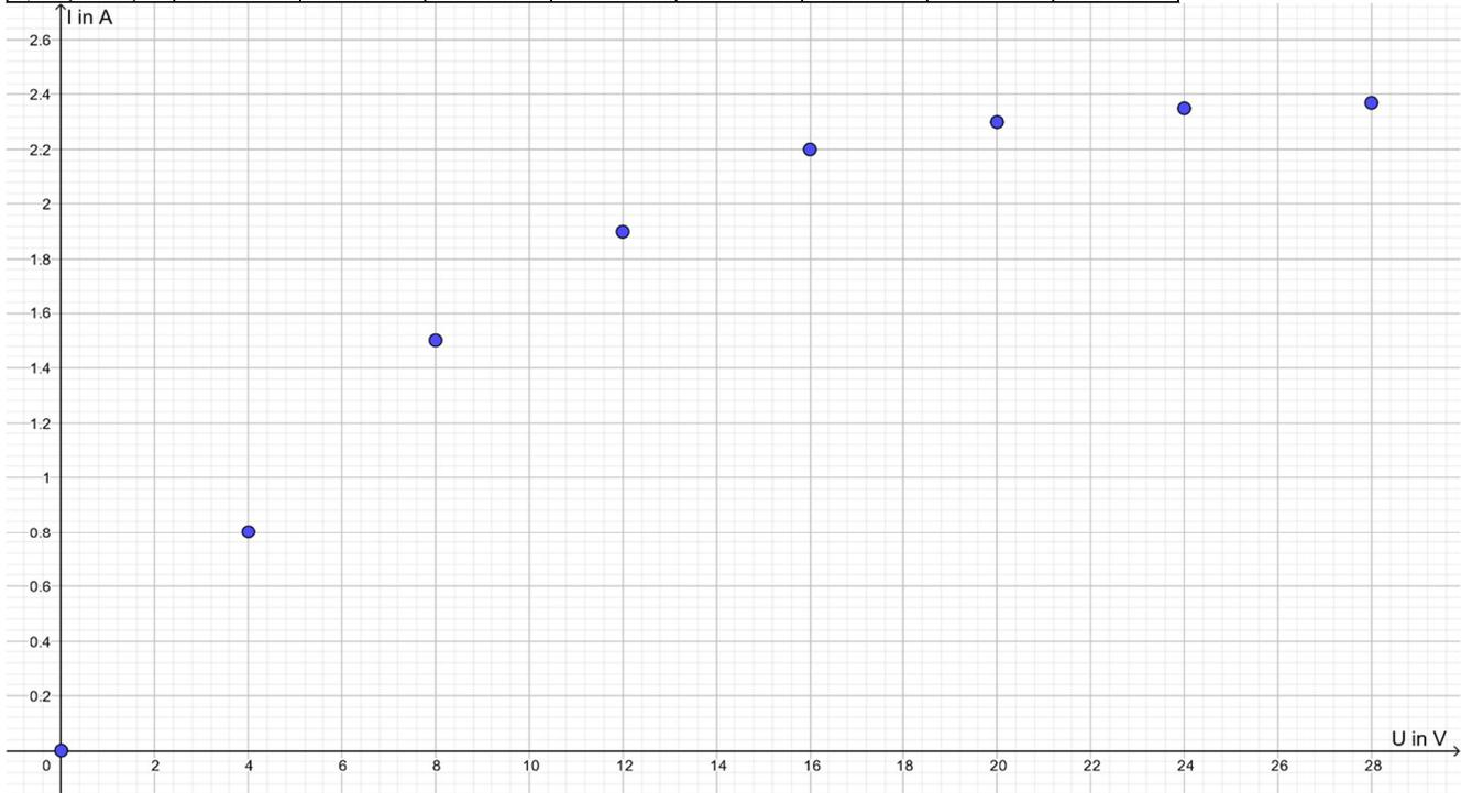
b)  $U/I$  ist nicht konstant, Spannung und Stromstärke sind hier also nicht proportional zueinander. Die Messpunkte liegen deshalb auch nicht auf einer (Ursprungs-)Geraden. Der Eisendraht gehorcht nicht dem Ohm'schen Gesetz.
