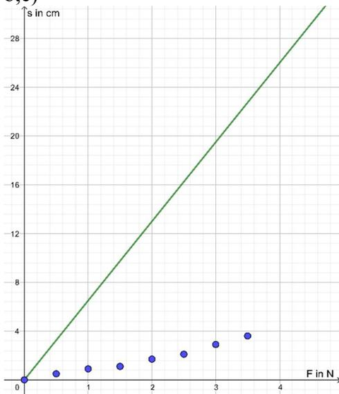
c) Der Graph ist eine Gerade.  $s = 6,5 \frac{\text{cm}}{\text{N}} \cdot F$  (bzw.  $y = 6,5x$ )
