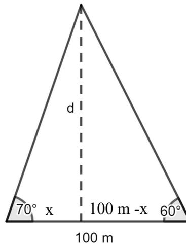
„Links“ hat man nun ein rechtwinkliges Dreieck mit der Gegenkathete  $d$  und der Ankathete  $x$  zum  $70^\circ$ -Winkel; „rechts“ hat man ein rechtwinkliges Dreieck mit der Gegenkathete  $d$  und der Ankathete  $100\text{ m} - x$  zum  $60^\circ$ -Winkel. Also kann man in beiden Dreiecken jeweils den Tangens verwenden:
