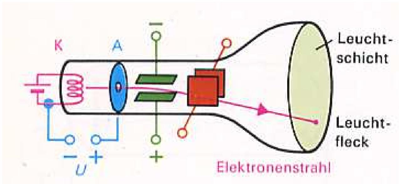
1. Welche Wirkung hat eine konstante Spannung am grün bzw. am rot gezeichneten Plattenkondensator jeweils auf die Elektronen?
