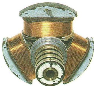
Die Spule ist so gewickelt, dass ihre Windungsebenen zu zwölf verschiedenen Ebenen parallel sind; nach jeder Drehung um  $30^\circ$  wird umgepolt.
