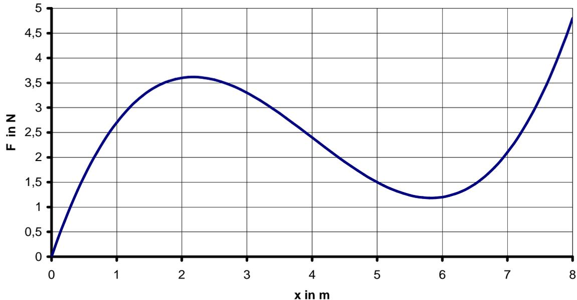
Da die Kraft offensichtlich entlang des Weges nicht konstant ist, kann man hier für die Arbeit nicht einfach die Formel  $W = F \cdot x$  verwenden. Eine gute Näherung für die gesamte geleistete Arbeit bei einer Bewegung von  $x = 0$  bis  $x = 8$  erhält man aber, wenn man annimmt, dass die Kraft jeweils auf einer Wegstrecke von 1 m in etwa konstant bleibt. Als Wert für die konstante Kraft in jedem Intervall kann man sinnvoll z. B. den Mittelwert aus Anfangs- und Endkraft nehmen.
